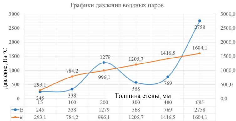
Рис. 2. Кривые распределения парциальных давлений действительного (e), максимального (E) водяных паров
