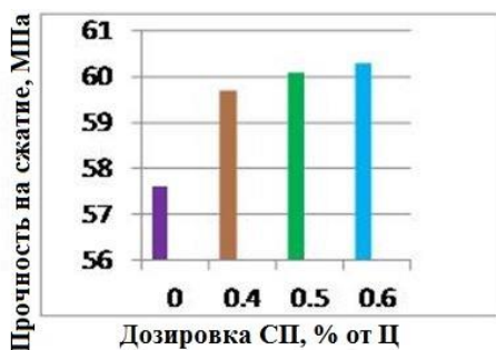
Рис. 2. Влияние SikaViscocrete на прочность при сжатии на 28 суток
