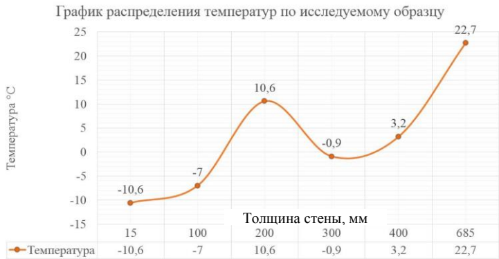
Рис. 1. Кривая распределения температуры в наружном ограждении (материал-кирпич): температура наружного воздуха -15° С
